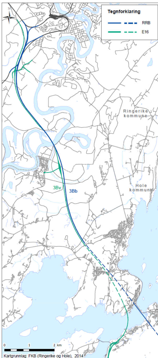
Figur 13: Skisse som viser mulig felleskorridor for veg og bane Krossund - Hønefoss basert på tidligere utredede løsninger for Busundlinja/grønn korridor
