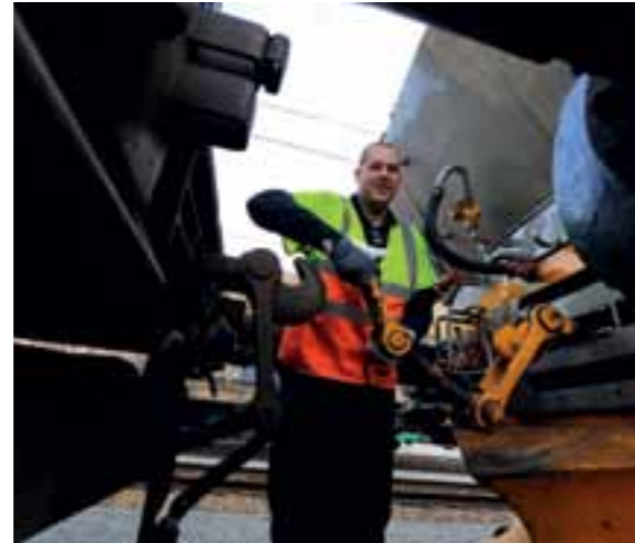
16:38: Lokfører Kim Johansson kobler fra lokomotivet. Herfra og ut på kaia er det ikke kjørestrom og vognene blir trukket av et skiftelok.
