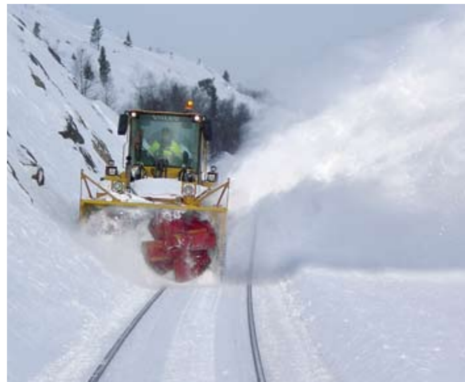
GODVÆR: Ved at vi benytter godværsperiodene til å fjerne snø ved siden av sporet vil ikke neste styggværsperiode så fort legge snømengder inn mot baneprofilen.
