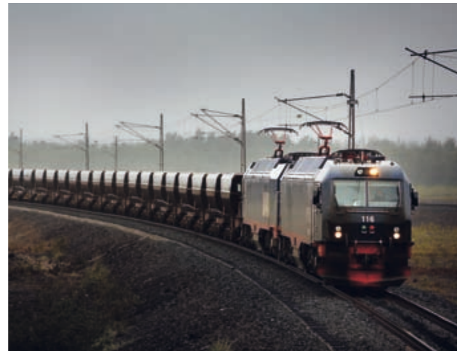
NYTT: Malmtrafikk AS har satt inn nye vogner med 30 tonns aksellast, og de trekkes av IORE – Europas kraftigste loktype. FOTO:LKAB
