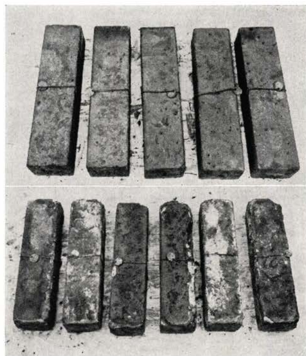
Fig. 3. Betongprøver med 390 kg vanlig norsk portlandcement pr. m 3 . v/c = 0,50. Lagringstid 5 år og 9 måneder. Øverst: prøver lagret over lavvann. Nederst: prøver lagret neddykket nær bunnen.
