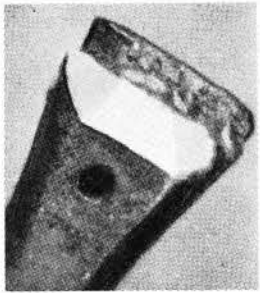
P 1. Platen knust, hardmetall sitter igjen i sporet.
