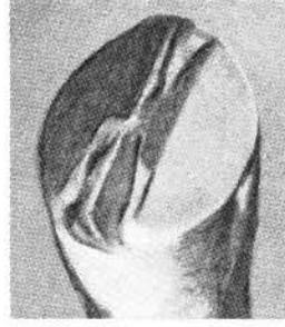
P 11. Langsgående sprekker.
