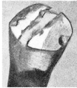
P 1. Platen knust, hardmetall sitter igjen i sporet.
