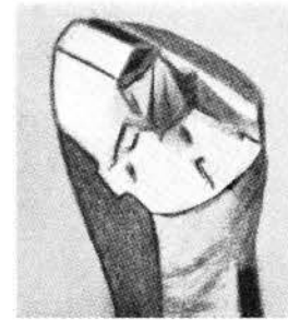
P 9, P 10. Del av platen, og halve flanken borte på le-siden eller støtsiden.
