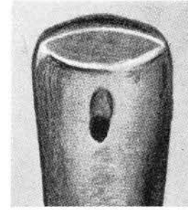
P 12. Motkon grunnet dårlig etterslipning.
