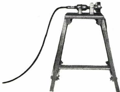
Fig. 7. Håndslipemaskin montert på stativ.
