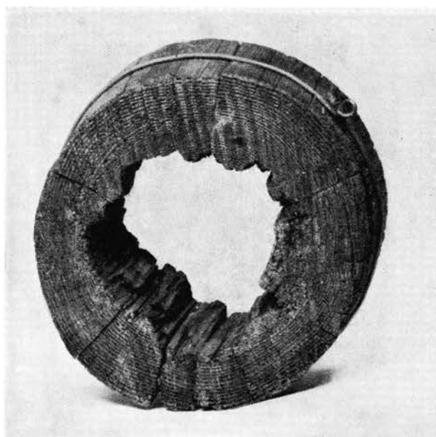
Fig. 8. Topp av en avkappet ubeskyttet gjerdestolpe etter 19 år.
