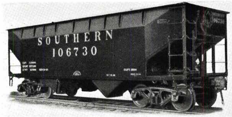
50 tonns bunntømningsvogn for massetransport.
