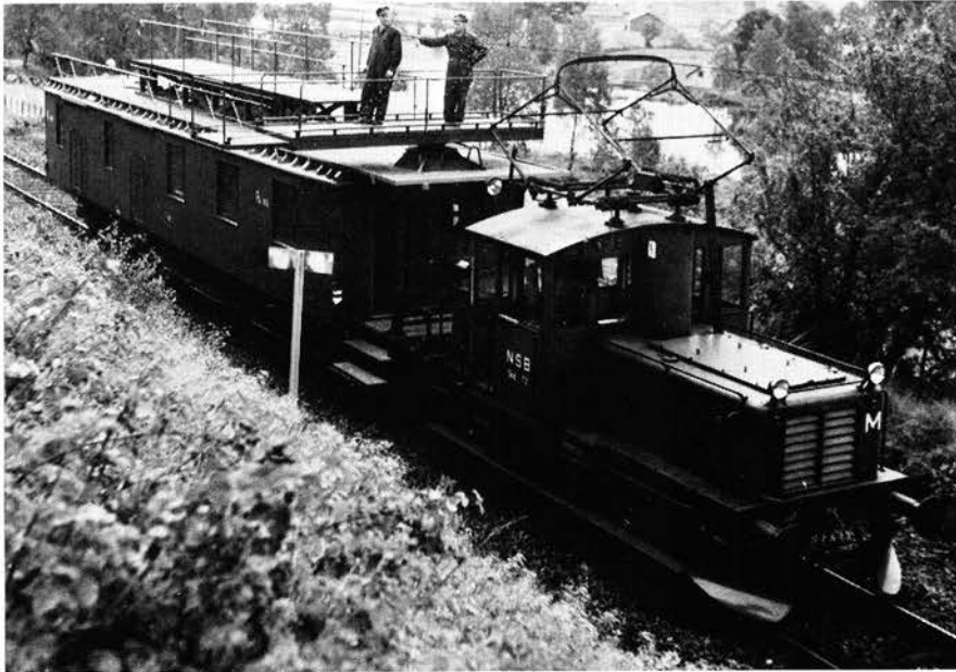
Nåværende standardmateriell for revisjon av kontaktledningen.
