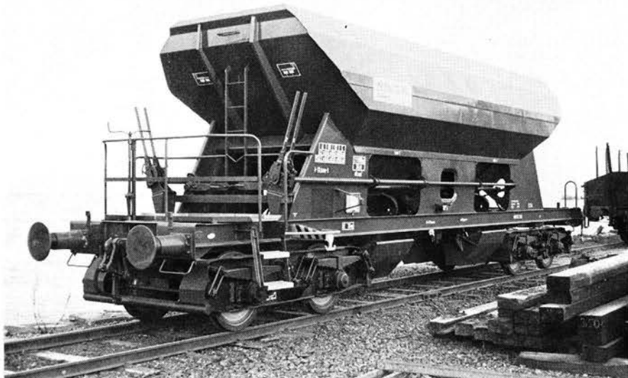
Bildet viser en av B.avd. nye bunntømmingsvogner.
