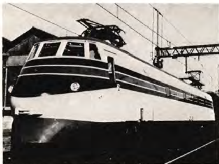
Fig. 27. Y0160, FS/FIAT's forsøksvogn med servostyrt krenning.
