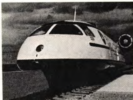
Fig. 1. Forsøksvogn for lineære elektromotorer. Oppnådde 410 km/h i 1974.
