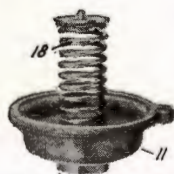
Fig. 65. Stempel (11) med belastningsfjær (18).
