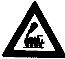
134.2 Jernbaneplanovergang uten grind eller bom.
