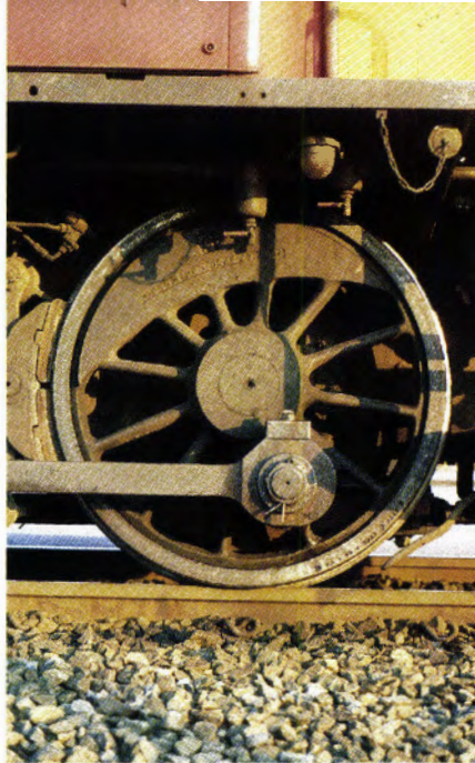
Hjul mot skinne – liten friksjon og stor sikkerhet. Hjulet har en utstående kant – en flens – som går nedenfor skinnetoppen og holder hjulet på plass mot innersiden av skinnen. (Foto i 1997: Jan Erik Hellerud.)
