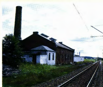
«Hvite sviller» varte ikke mange årene. Men med impregnering av steinkulltjære – også kjent som kreosot – kunne svillene ligge i årevis. Impregneringsverk fantes flere steder, bl.a. her i Råde i Østfold. (Foto: NSB Arkitektkontoret.)
