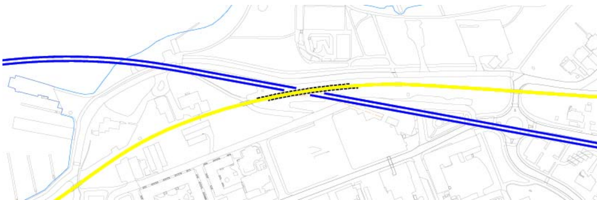
Figur 132 Utsnitt av fase 00.50 nord for Hamarbukta. Utsnittet viser kryssingspunkt mellom ny og eksisterende bane (ICP-57-Y-12104_00A)
