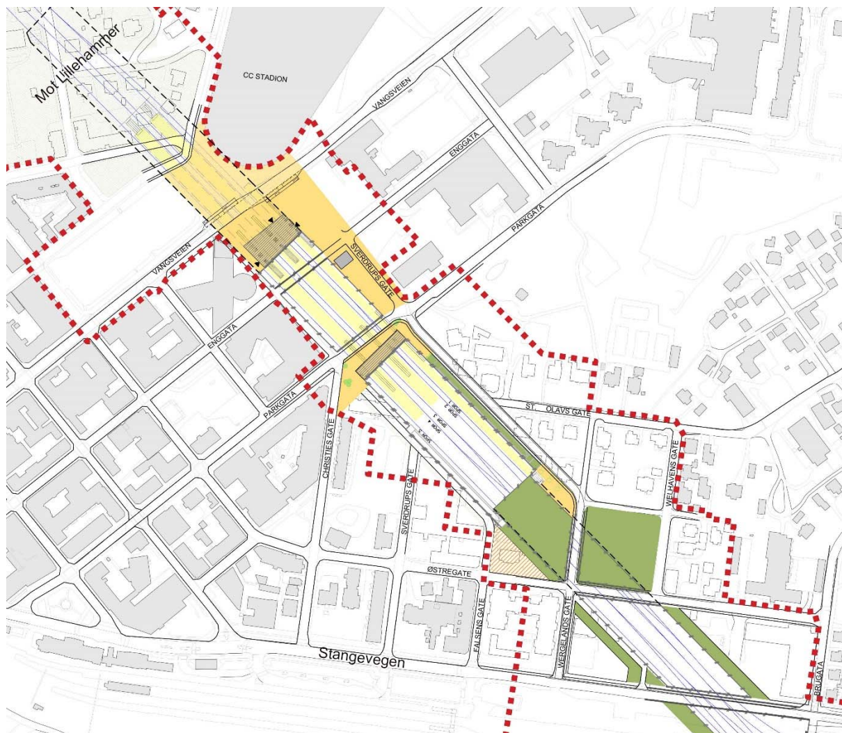
Figur 127 Hamar, korridor 2 midt, variant 1a stasjon rådhuset mellom (størrelse på) lokk. Det er lokk over plattformer fra Vangsvegen og nordover
