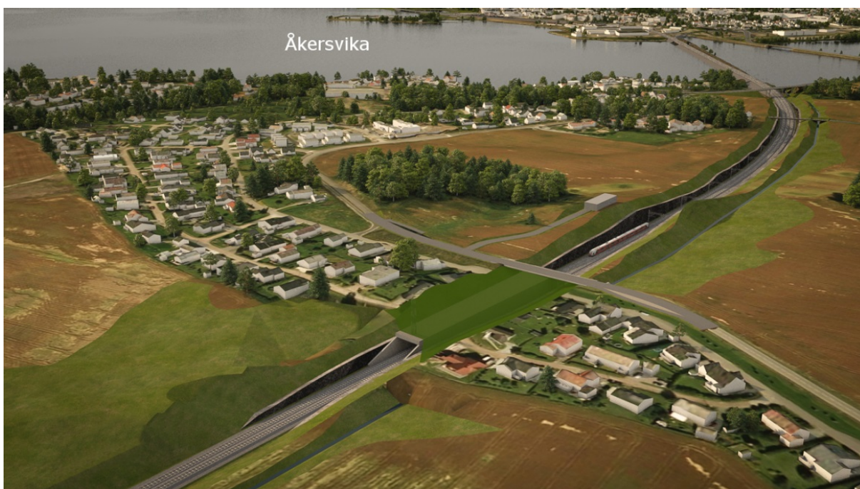
Figur 40 Bekkelaget, kulvert, alternativ K1-2b. 2 spor inn i kulvert fra sør og 3 spor i nordenden av foreslått kulvert (125 m)
