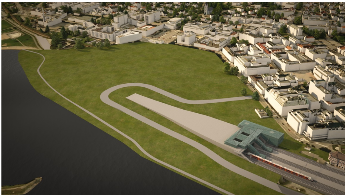
Figur 121 Alternativ K1-3b med maksimal kulvert som starter rett nord for plattformene
