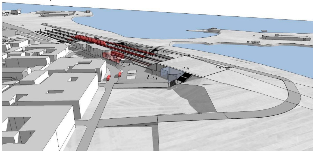
Figur 91 Hamar, alternativ 3b med full kulvert under Hamarbukta, med muligheter til nybygg ved reisetorget, sett fra nordvest over Strandgata. Utviklingsområdet mellom Mjøsa og byen blir mer fleksibelt i forhold til videre utvikling.
