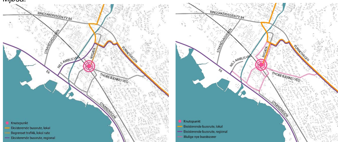
Figur 263 Illustrasjon til venstre viser dagens situasjon. Det er avsatt plass til bussholdeplasser i forbindelse med knutepunktet da det i fremtiden kan være ønskelig å trekke busser via stasjonen. I ill til høyre vises hvordan ny rute kan enten gå tur-retur i Nygata som på illustrasjonen eller via ny Nils Ambliis veg på bakken. For regionale busser kan det være aktuelt å benytte Brennerivegen.
