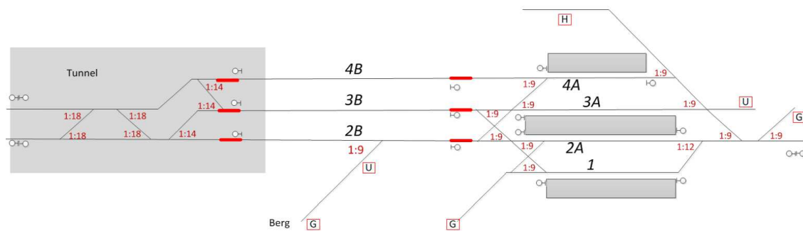
Figur 11-3: Skjematisk sporplan Halden stasjon 2031 IC-2 alternativ 2. Spor mot Berg er eksisterende spor. Fra konseptdokumentet [3]
