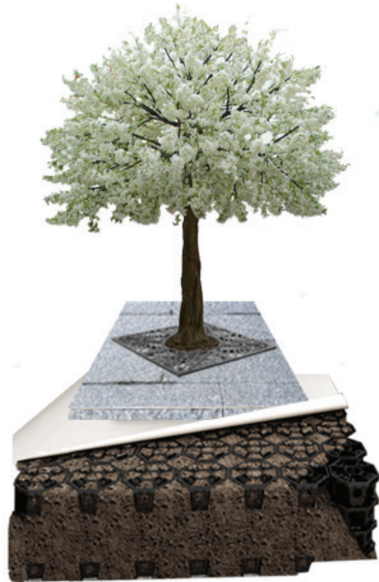
Figur 119 Illustrasjonen viser hvordan trærne skal anlegges med celledøsning. Deler av illustrasjonen er hentet fra; Gooden(2016)
