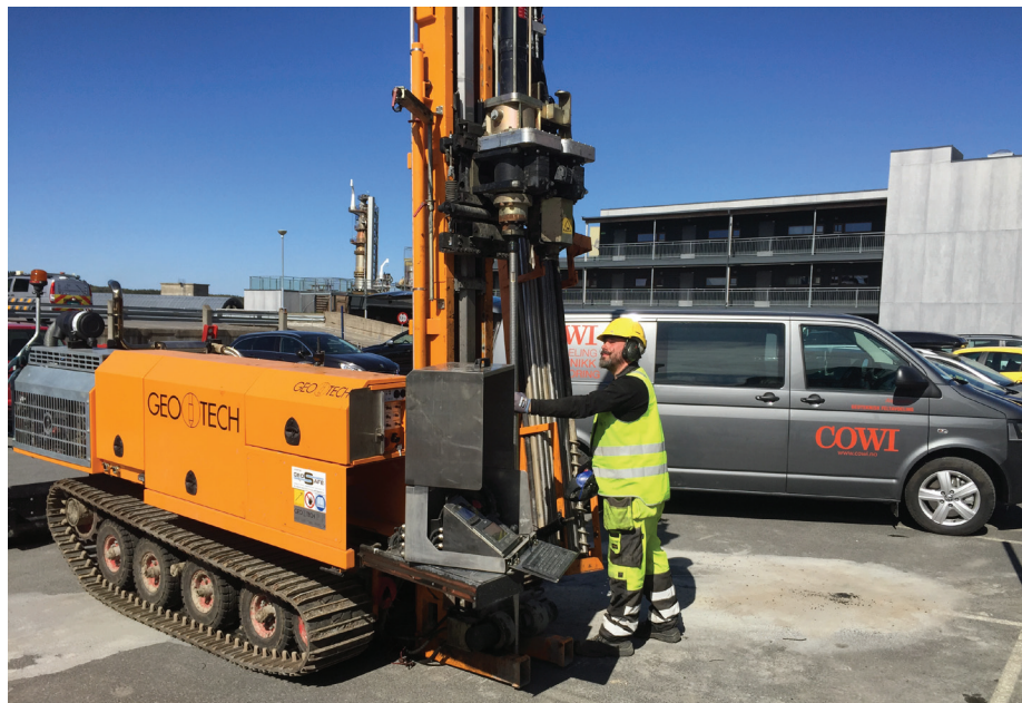
Grunnundersøkelsene utføres med beltegående borerigger. (Foto: COWI)
