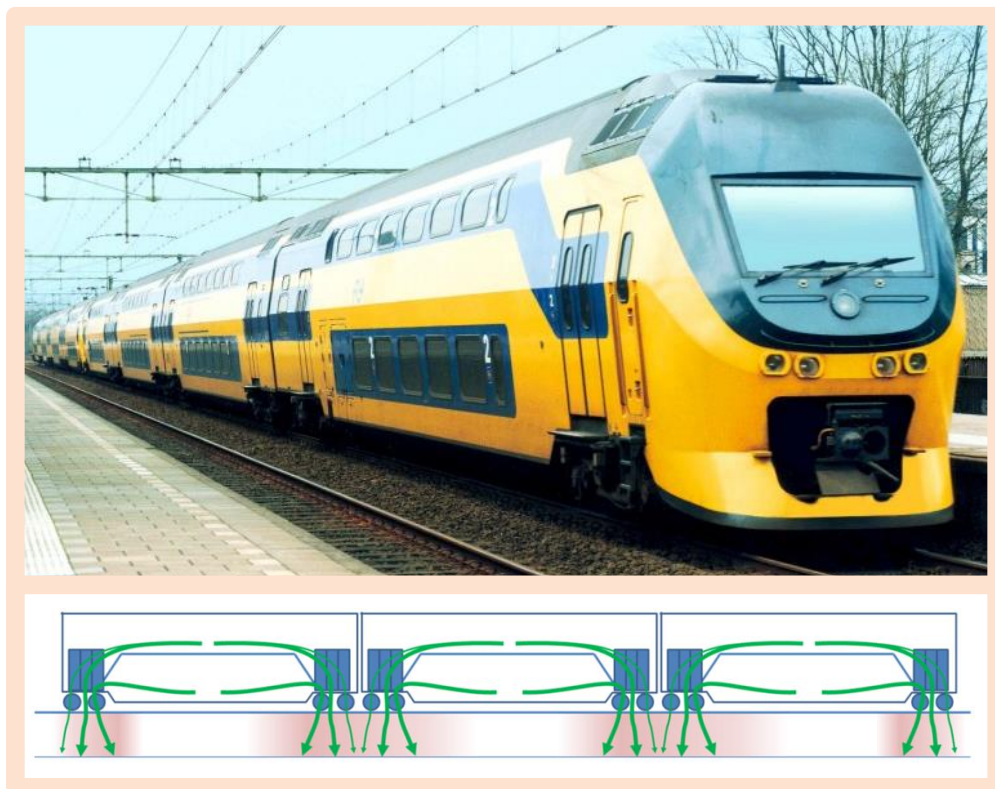
Figur 12: VIRM IV, et Toetasjes tog i Nederland med dører mellom 1. og 2. etasje. Foto og figur: Bombardier og NSB [26], [25]
