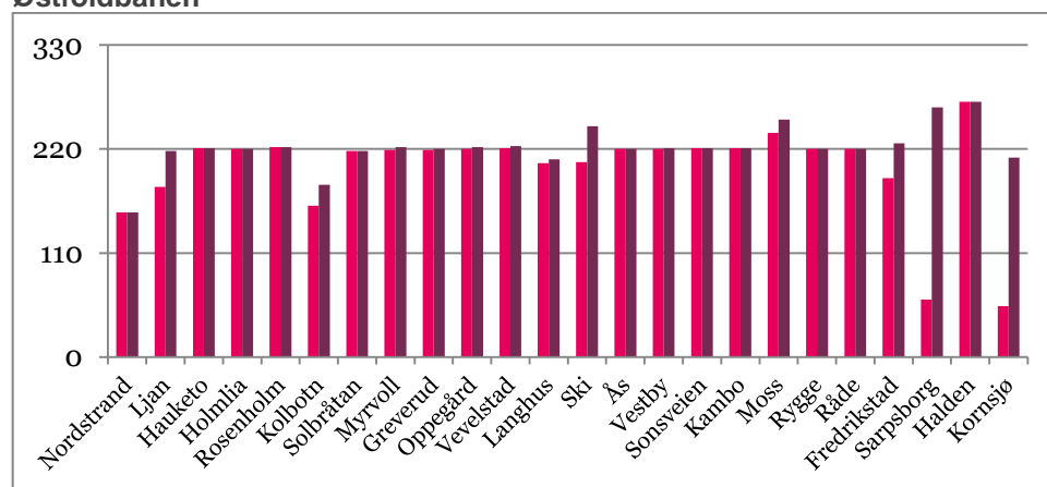
Figur 38: Plattformlengder på Østfoldbanen. Merknad: plattformene på råde er forlenget til 220 m. [58]
