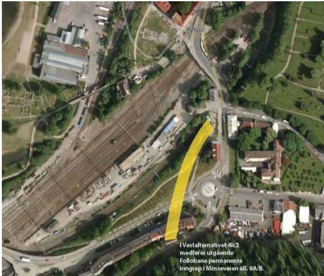
Figur 57 Kulvert for utgående Follobane i Vestalternativet.
