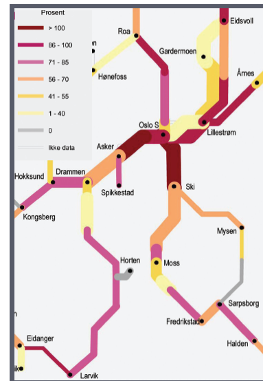
Figur 3. Kapasitet i rushtimen på Østlandets jernbanelinjer (Jernbaneverkets kapasitetsrapport 2008). Skøyen - Asker bygges nå ut, Oslo - Ski vil fortsatt være overbelastet..
