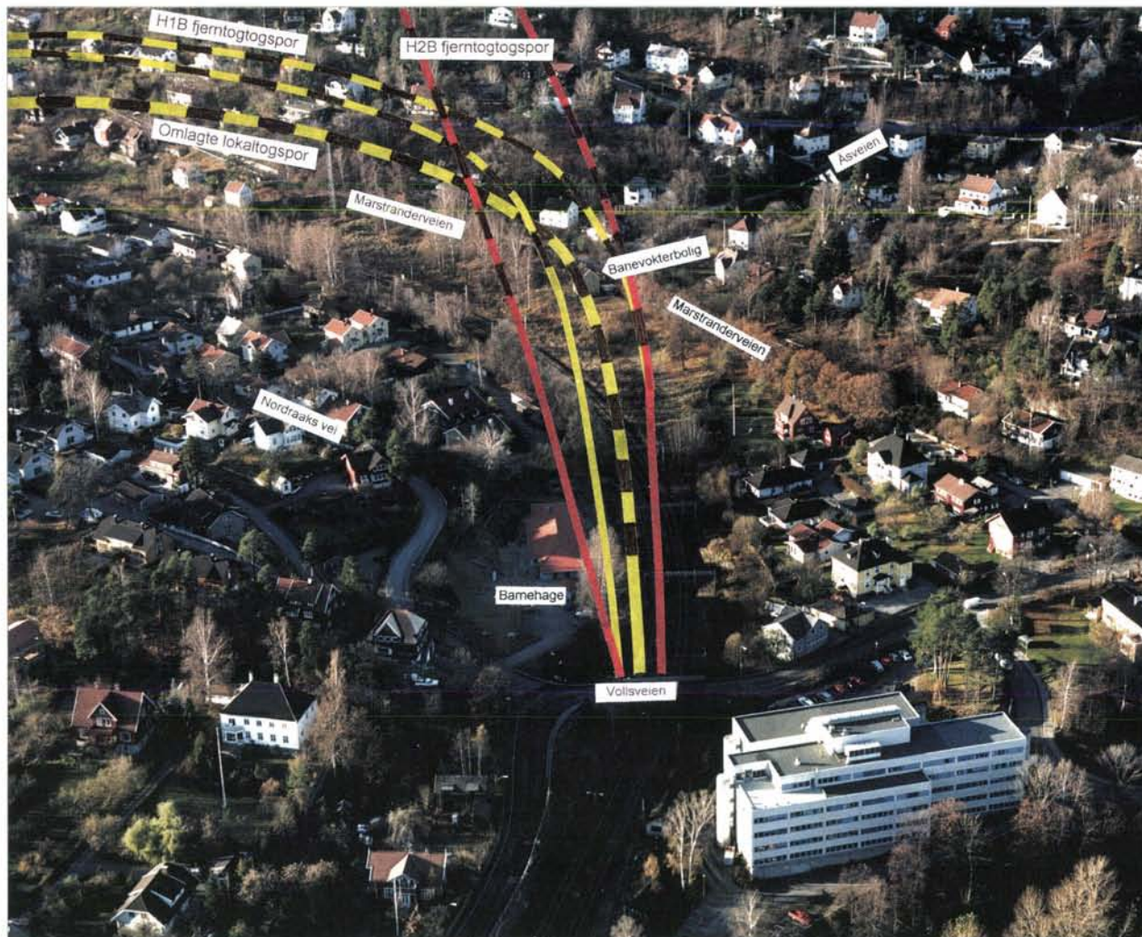
Fig. 8.5.1 Lysaker vest sett fra Vollsveien mot vest. Rød linje er hurtigtogspor for alternativ H2B. Smale gule linjer er hurtigtogspor for alternativ H1B og tykk gul linje er omlagte lokaltogspor for alternativene H1B og H2B. (Fotonor AS)
