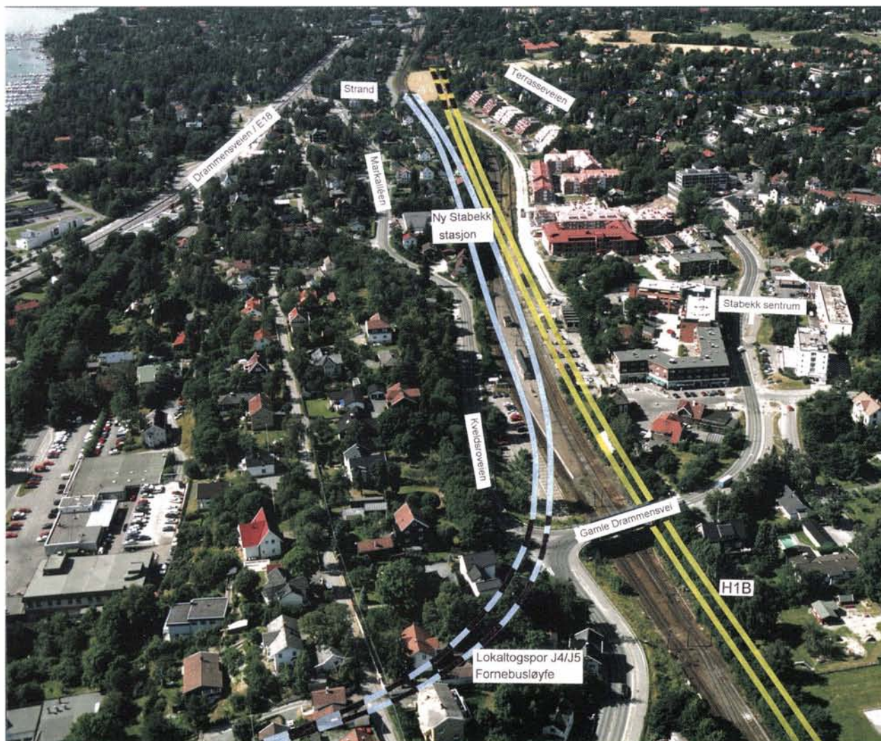
Fig. 8.6.1 Stabekk stasjon sett fra øst mot vest. Gule linjer viser hurtigtogsporene for alternativ H1B. Blå linjer er lokal-togspor fra Fornebu for alternativ J4/J5. (Fotonor AS)
