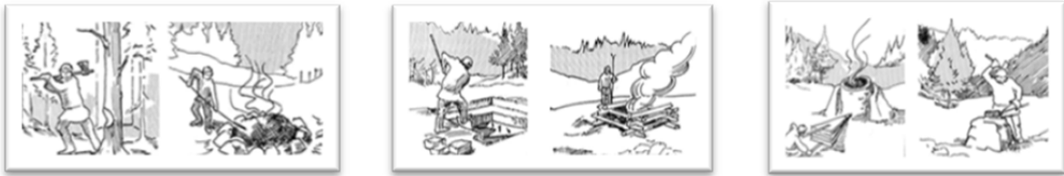
Figur 1: Jernfremstillingsprosessen. 1) Hugging og kullfremstilling. 2) Uttak av jernmalm og røsting. 3) Blestring og smiing. Tegning: Geir Helgen (Historieboka.no).
