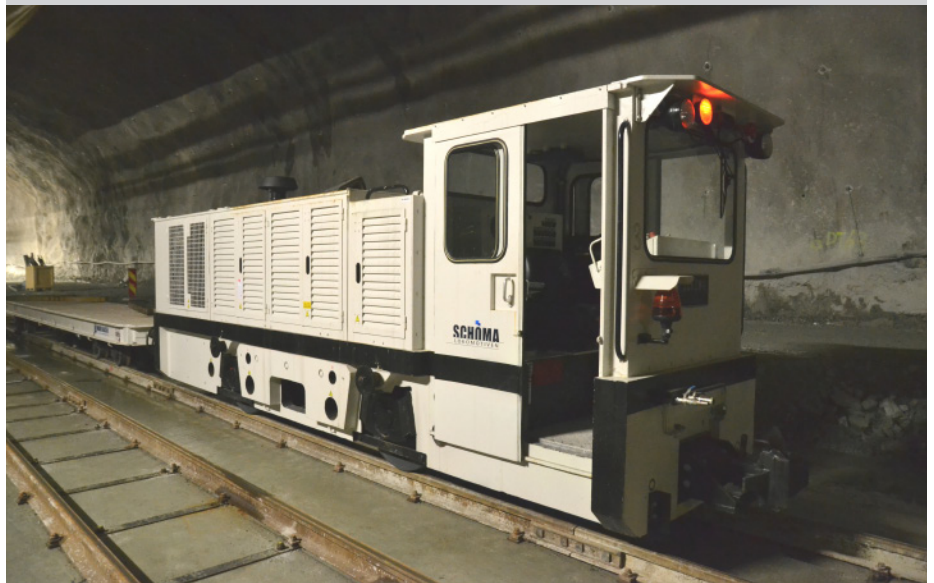
Et eget arbeidstog frakter mannskap og materiell inn til tunnelboremaskinen.
