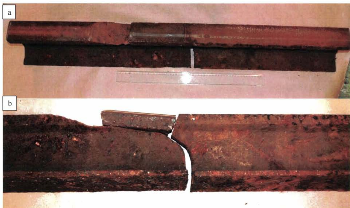
Figur 1ab: Bilder av jernbaneskinne som mottatt for skadeundersøkelse.
