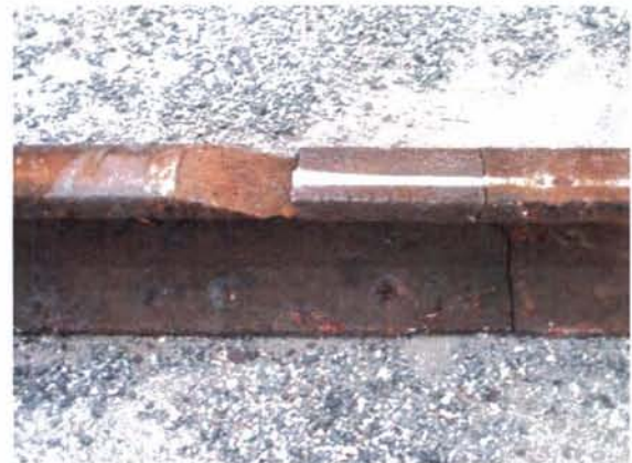
Figur 2: Skinnebruddet etter at en løs del er lagt på plass. Den manglende biten ble ikke funnet. (Foto: JBV).
