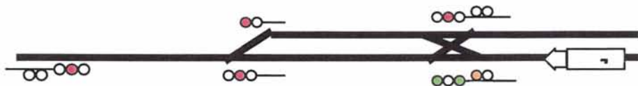
Eksempel på indre hovedsignal som viser kjørsignal. Forsignal for utkjørhovedsignalet viser "vent stopp".
