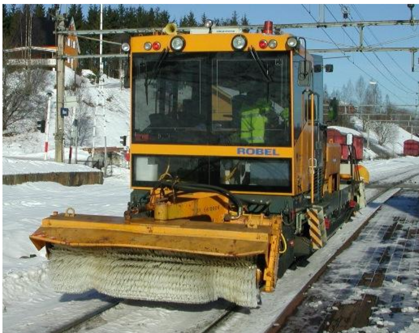
Figur 3-11 Robel lastetraktor med snøkost foran og etterhengt sporrensere for rydding av linjen bak. [32]
