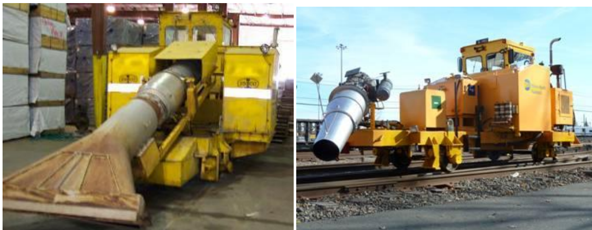
Figur 3-16 T.V. Essco Jet snow blower, GE jet motor fra Detroit.[54] T.H Ny Metro north maskin [53]
