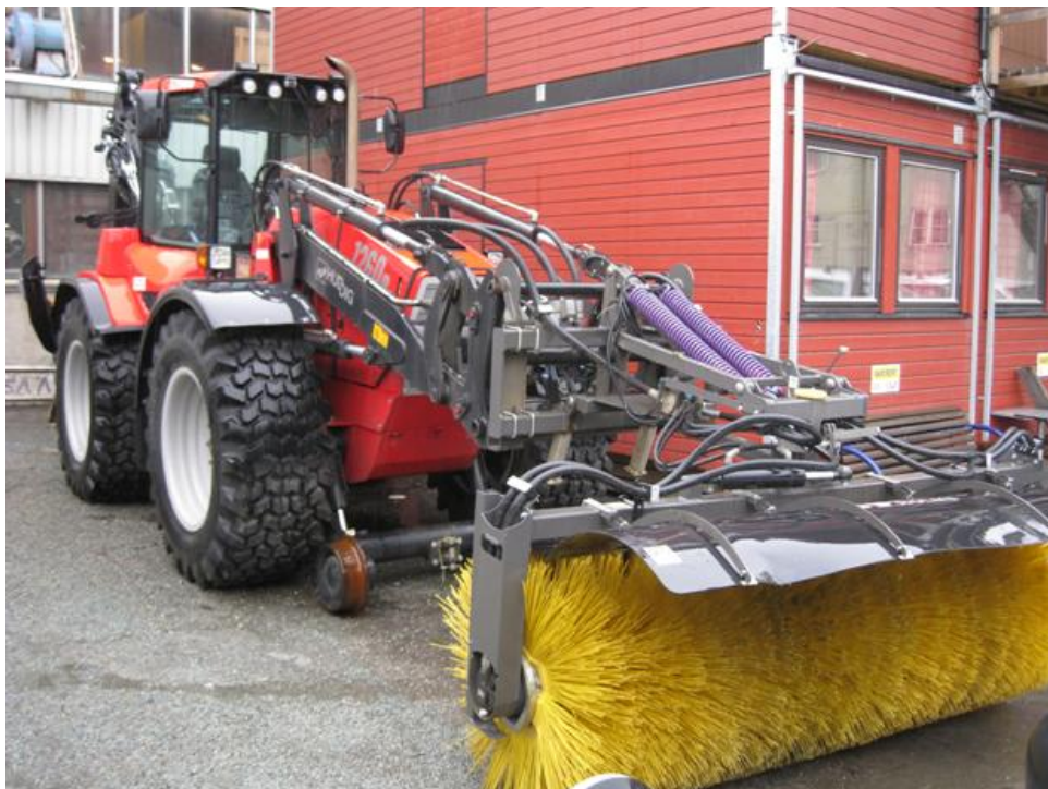
Figur 3-7 Traktor med hjulsett for skinner og påmontert børste på Marienborg [Foto: Johann Helgi Oskarsson]
