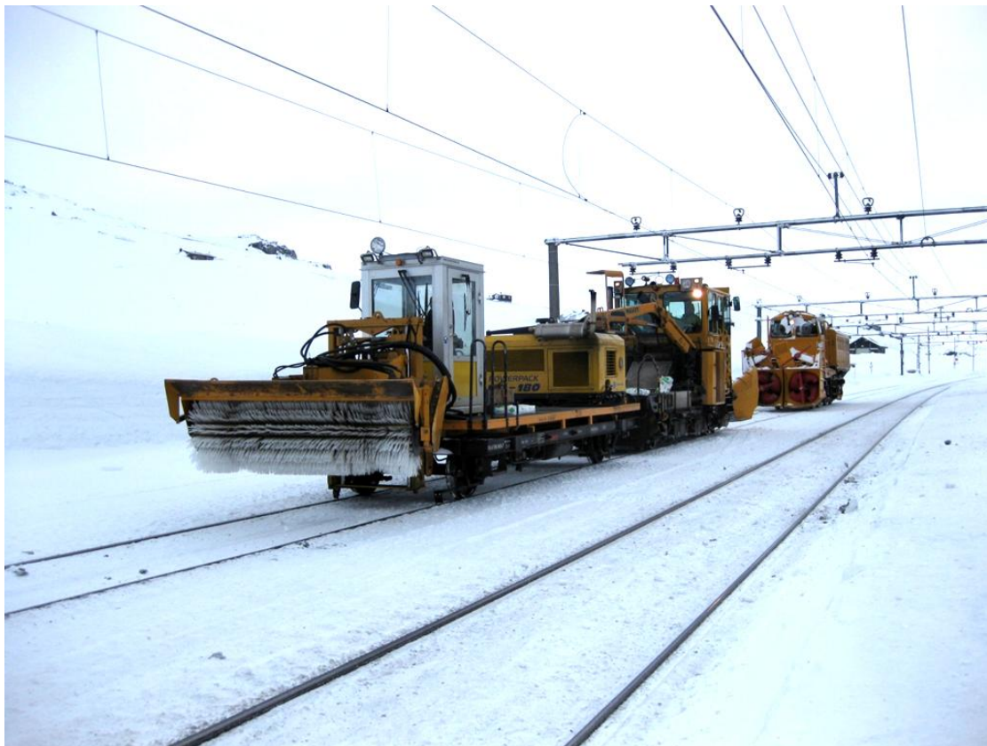
Figur 3-10 Fresemaskin og kostemaskin på Finse. Snøfjerning i flere operasjoner. [66]
