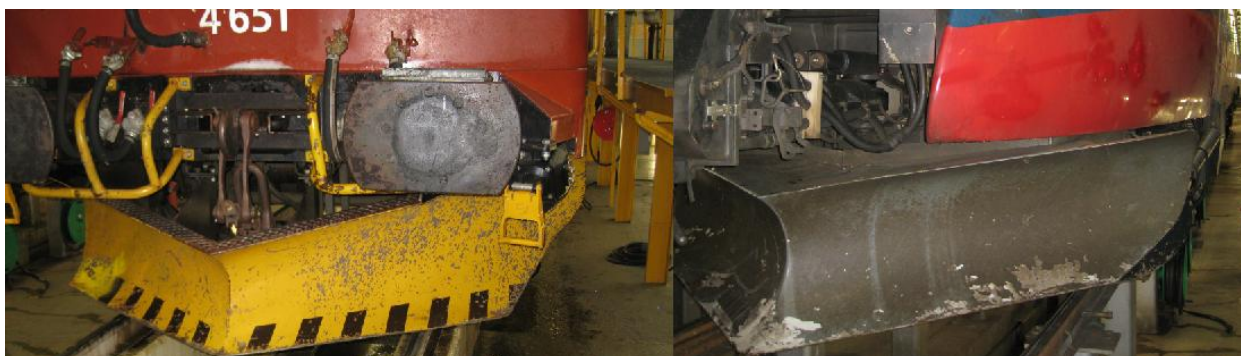
Figur 3-8 Underhengt lavplog på to vanlige lokomotivtyper [Foto: Johann Helgi Oskarsson]
