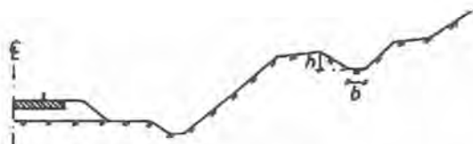
FIGUR 4-14 Terrenggrøft innenfor topp av skjæring
