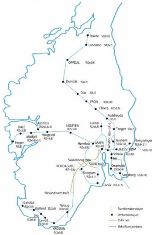
Kartet viser Bane Energis omformerstasjoner i Norge. (R = roterende aggregater og S = statiske aggregater. Tallene i parentes viser aggregatenes ytelse i MVA, første siffer viser antall aggregater.) Stasjoneringer er navngitt med store bokstaver.
