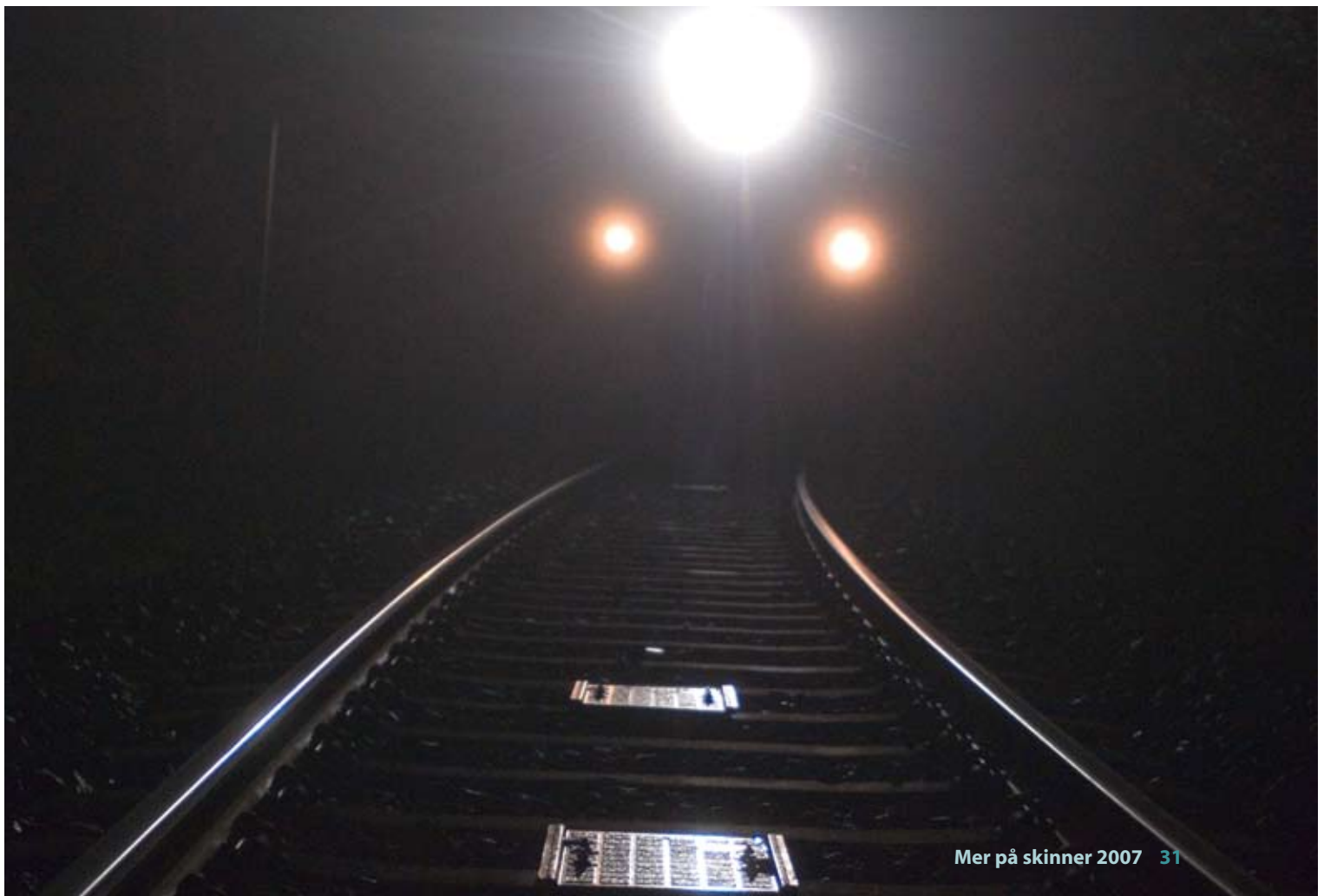
ATC-baliser: Festet til svillene i sporet og kommuniserer med togets ATC-system. Benyttes i signalanlegg bl.a. til hastighetsovervåking av tog.
