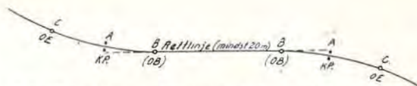
Ved løftning for overhøiderampe settes sikteskiven altid i overhøiderampens begyndelses- og endepunkt.
