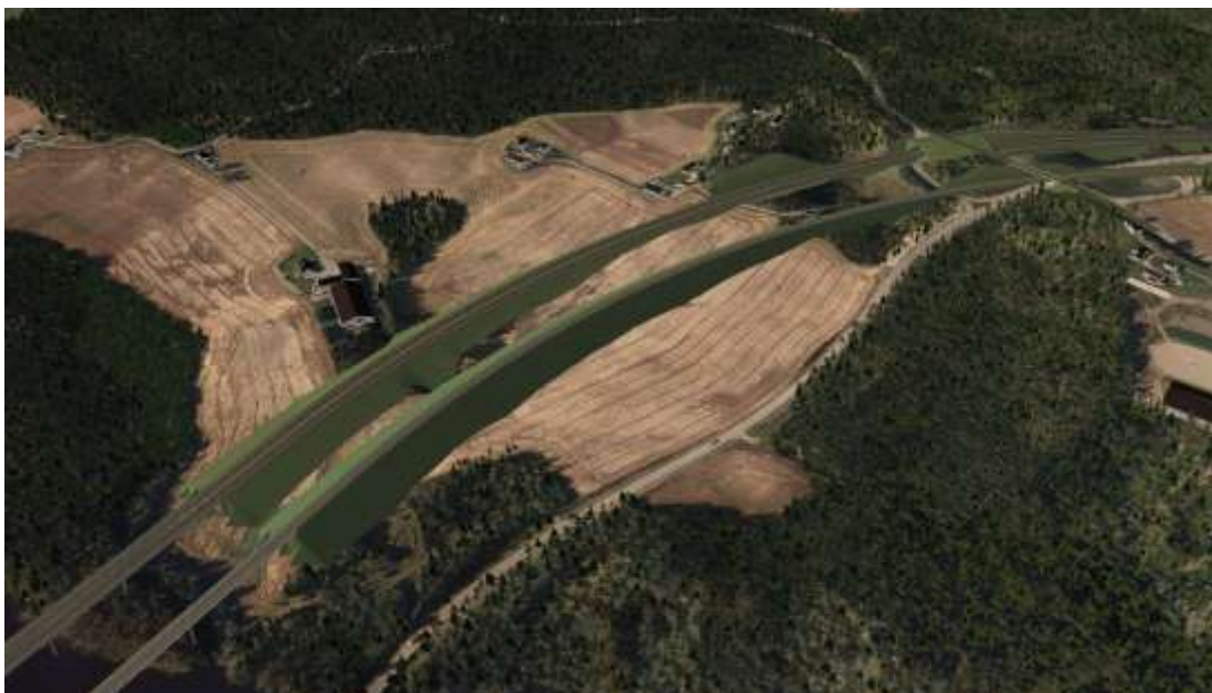
Figur 4.60. Modellutsnittet viser linjene i alt. 4e-e nord for Storelva, på høye fyllinger over jordene inn mot Styggedalen. Sett fra øst.
