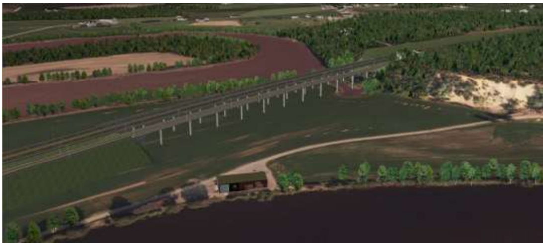
Figur 4.44. Modellutsnitt viser hvordan viadukten ivaretar visuell sammenheng mellom elverommene, men også hvordan fyllingen dominerer jordbrukslandet, og hvordan anlegget skjærer seg ned i terrassen ved Prestmoen. 4af-af sett fra øst.
