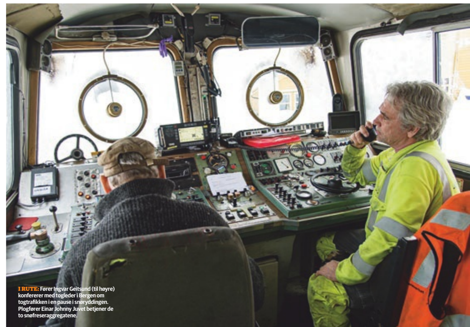
FISKEBÅT-VINDU: De roterende vinduene, som også brukes på fiskefartøy, gjør det mulig å se ut når snøfokket står på som verst.
