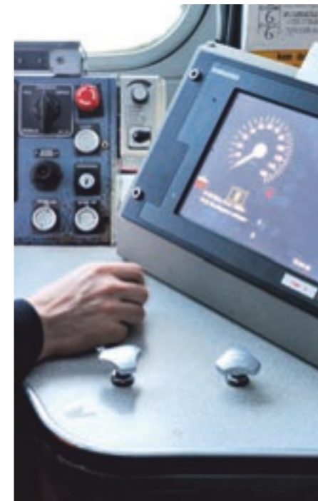
NYTT SIGNAL: Med ERTMS vil lokføreren få den informasjonen hun trenger inn i førerhytta.
