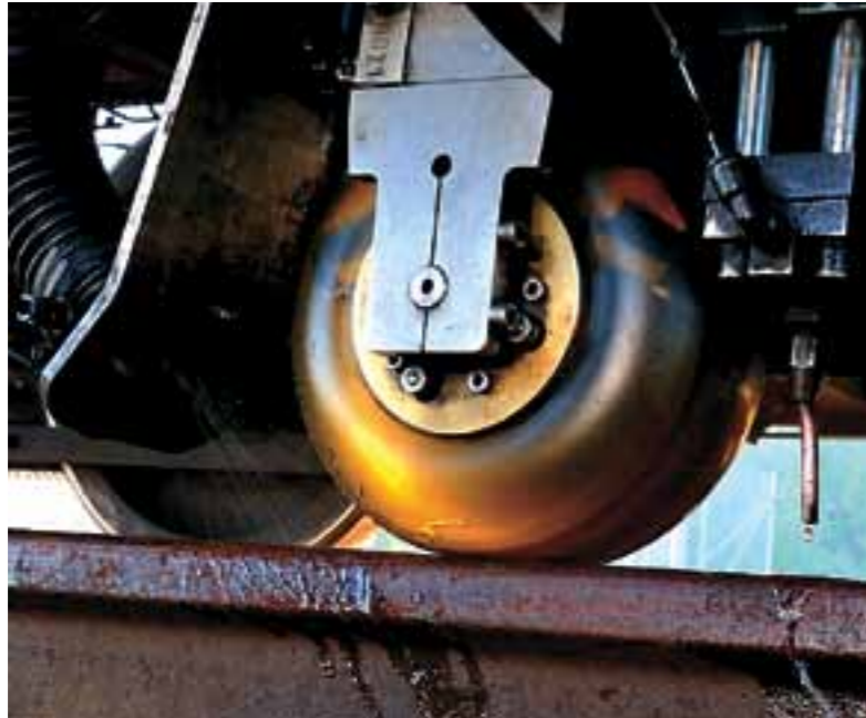
GJENNOMLYSER: Inne i dette avanserte hjulet sitter ultralydhoder som gjennomlyser jernbanskinna fra fem ulike vinkler. Dette utstyret triller over hele jernbanenettet i 40 km/t minst en gang i året.
