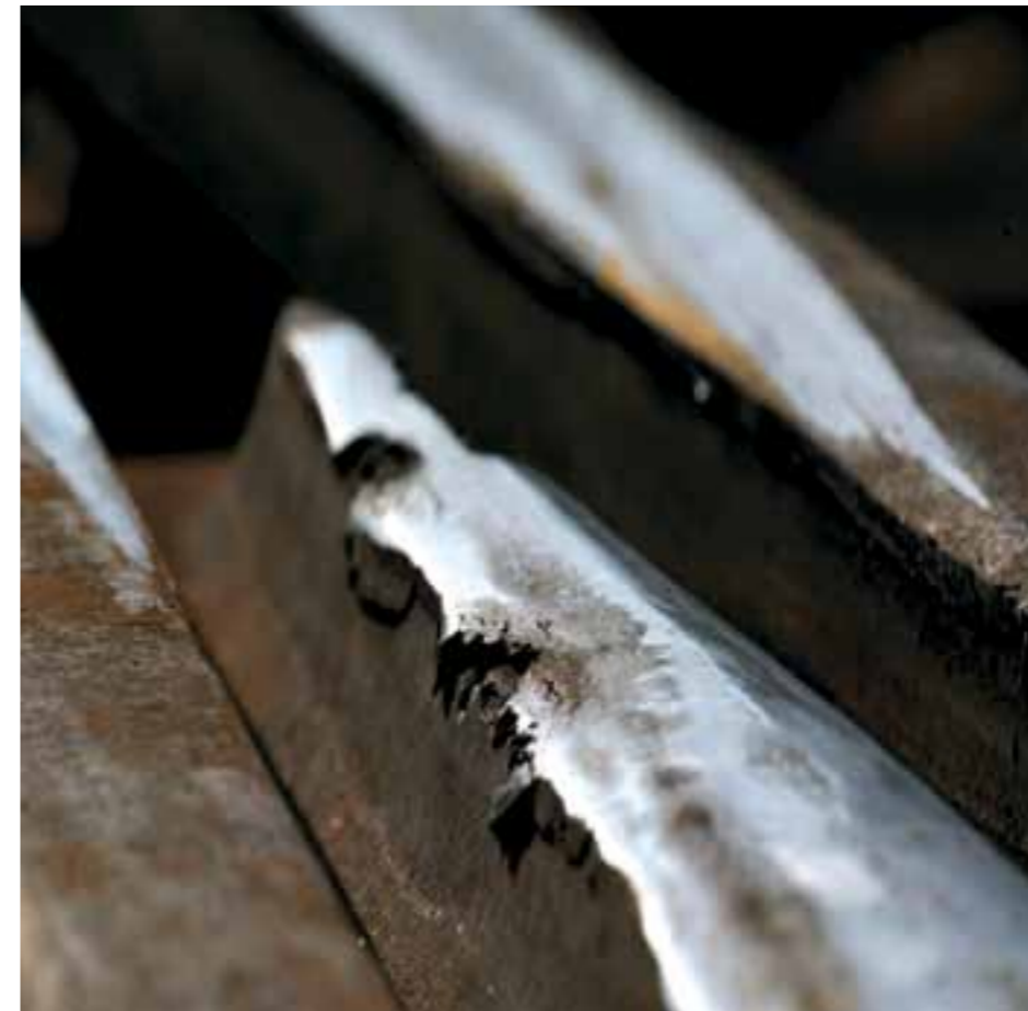
FRYNSETE: Etter 30 år med flere tog enn noe annet sted i Jernbane-Norge var sporveksler og spor frynsete og flatvalset på Oslo S før sommerens massive fornyelse.
