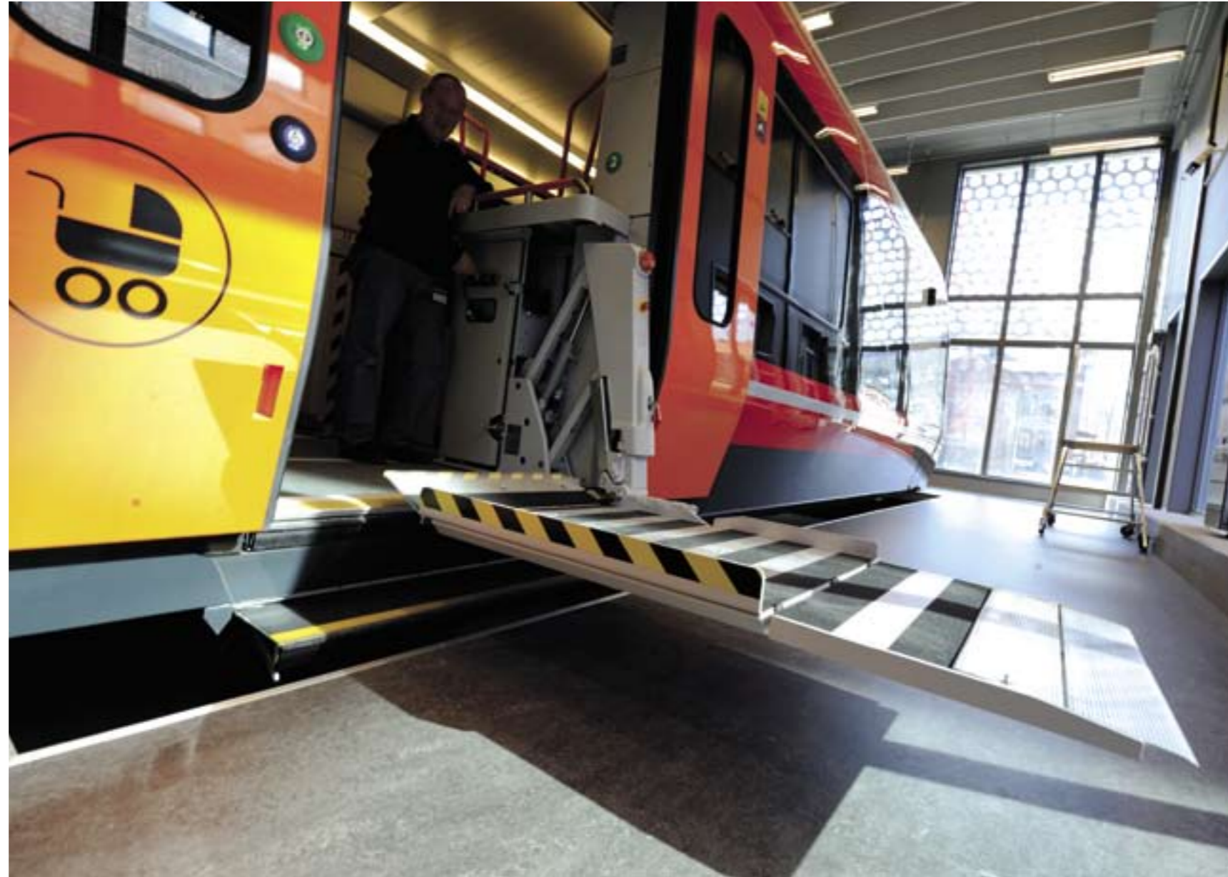
TRINN: NSBs nyeste Intercity- og lokaltogtype 74 og 75 er tilpasset alle plattformhøyder som eksisterer på stasjoner i Norge. I tillegg har toget stigtrinn for personale som må ut i pukken mellom stasjonene.
