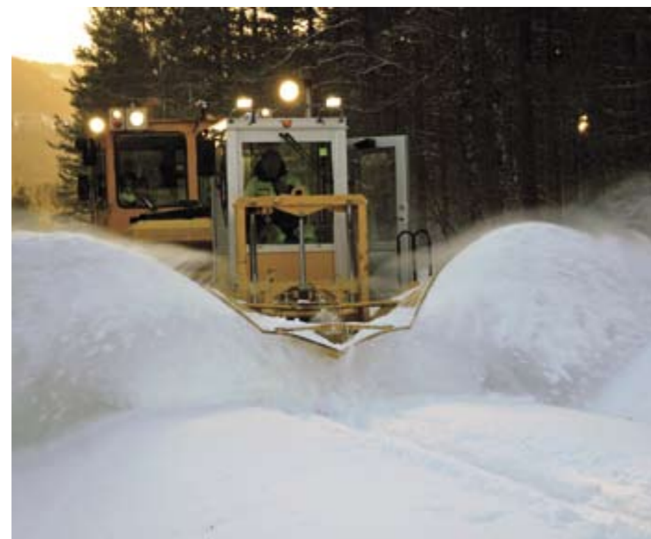
KONSENTRASJON: Tor Holm sit fremst og har som oppgåve å betene hydraulikken som hever og lægjer spissplogen ved planovergangar. Slik kan ein unngå at treverket i planovergangane blir gjort om til opptenningsved.
