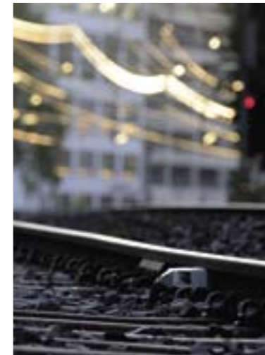
NYVINNING: Akseltellere, som forventes å redusere signalfeilene i sporfeltene i Oslotunnelen drastisk, er klar for prøvedrift mellom Oslo S og Lysaker i høst.
