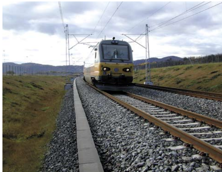
AVANSERT: Jernbaneverkets målevogn er fullstappet med elektronisk utstyr som kontrollerer og måler tilstanden i sporet.
