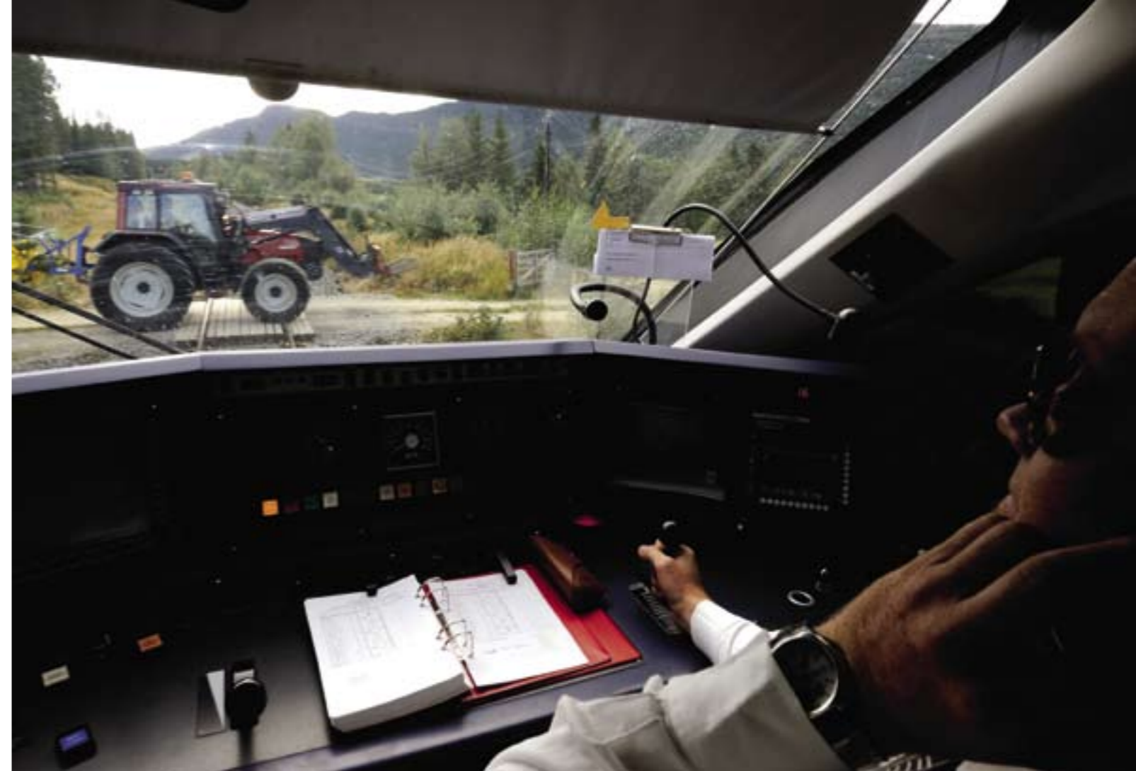
750 METERS BREMSELENGDE: Lokfører Helge Granheim i NSB kan sjelden eller aldri stoppe for en traktor som kjører ut i sporet. Dette viser en situasjon der Helge Granheim hadde hatt liten mulighet til å stanse. Bildet er arrangert.
