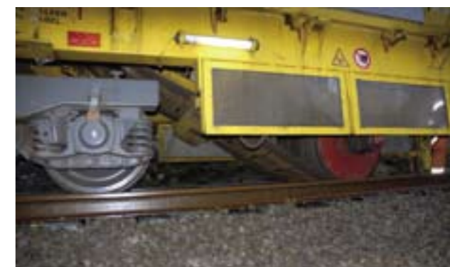
KRAFTIG MAGNET: I midten under en av vognene er en kraftig magnet som suger til seg de gamle svilleklemmene og frakter disse via transportbånd til en egen vogn. Klemmen er dratt løs fra sporet av en skinnegående traktor like foran SPOTen.
