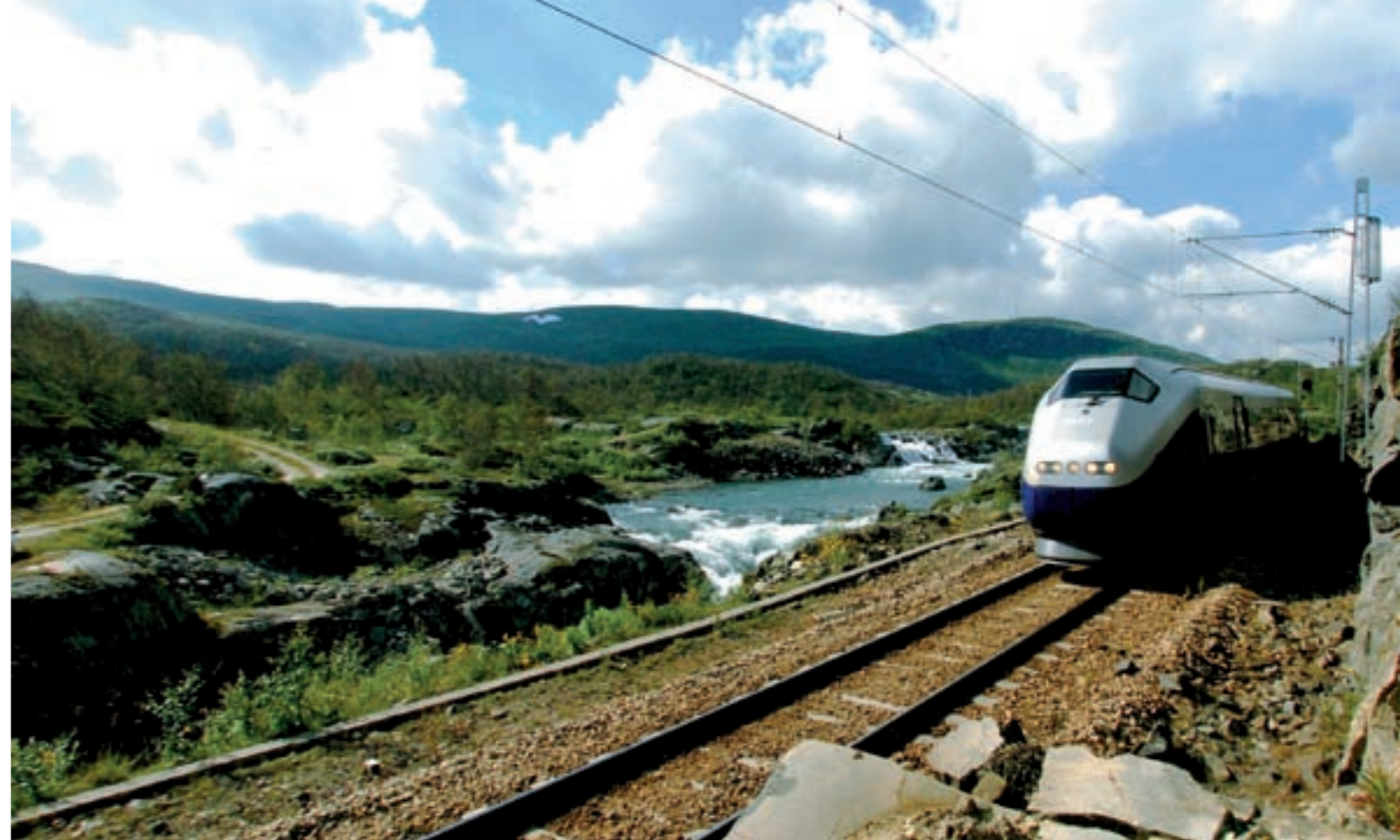
MILJØVENNLIG: Den norske togtypen 73 (tidligere Signatur) veier lite, gir liten luftmotstand og generer elektrisitet under bremsing.
