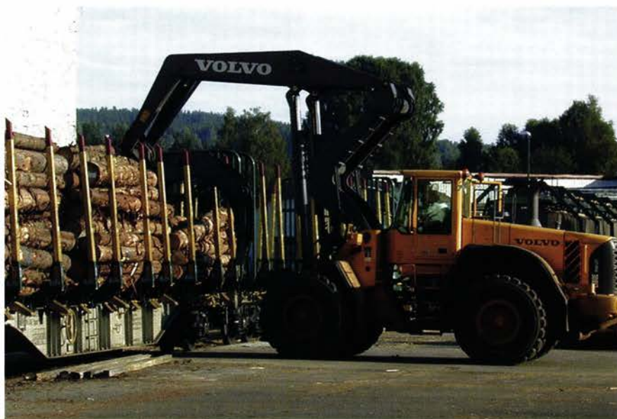
REVOLUSJON: Ofotbanen AS står bak en stille revolusjon i tømmertransporten. Selskapet har fått utviklet ny lasteutrustning på vanlige containervogner. Foto: OFOTBANEN AS
