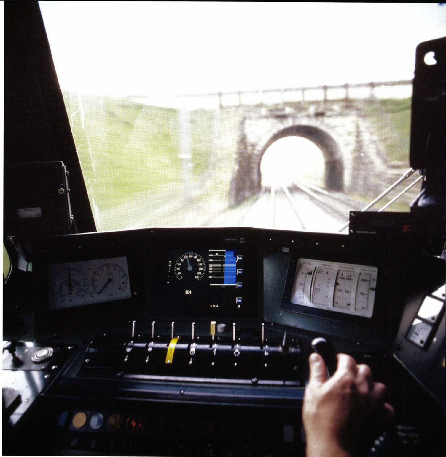
PANEL: All informasjon om hastigheter, kurver og andre tog sendes som radiosignaler til et panel hos lokføreren.
