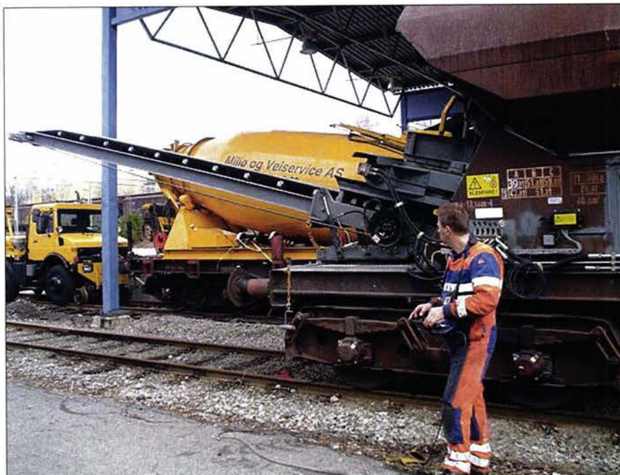
Pukkvoan: Ny pukkvoan fra firmaet Miljø- og Veiservice AS. I bakgrunnen en pukkuger.
