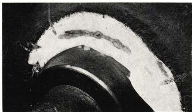
Fig. 9. Sprekk i hjulskive.
