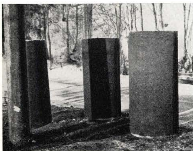
Fig. 8. Ferdige tamponger, 1,0 m lange, \varnothing = 0,50 m, med innvendig kjerne av grovkornig lok-slagg og ytre lag av finkornig lok-slagg. Tampongene er omhyllet av finmasket metallduk.
