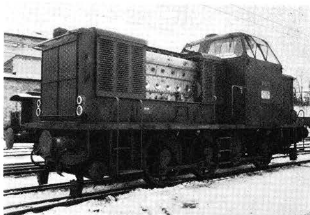
Fig. 1. Skiftelok. nr. 803 med Bergen diesel LT 6.
