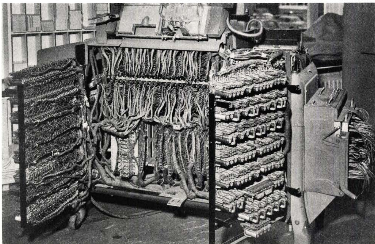
Fig. 7. Utsnitt av en tabulator med ledninger og reléer.
