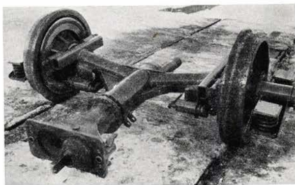
Fig. 20. KLL-togets hjulsats med innebygd sentralkobling og bremsstell.
