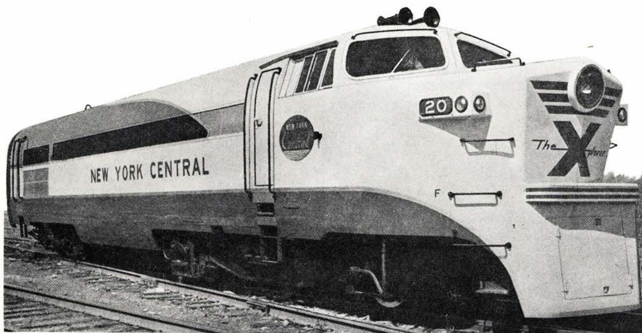
Fig. 12. «Train X» trekkes av et lokomotiv på 1000 hk med Mec-hydro transmisjon.
